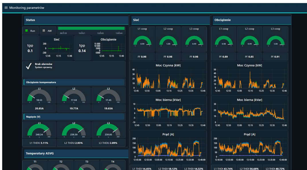
Przykład Dashboardu — monitoring parametrów po stronie sieci i obciążenia
